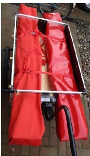
4. Planen (Dach & Thekenverblendung) in den Stoffsack (nie in den PVC Sack!) und diesen von hinten durch die andere Aussparung einschieben, bis er ebenfalls vorne ca. 30 cm herausragt.
