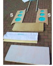
1.) Beide Seitenteile **\$** (höhere Seite ist hinten) durch Auflagestange **AQ** mit Stabilisierungsfläche an übereinander liegenden Scharnierpaaren vorne verbinden, textile Thekenverblendung hängt vorne herab, unten Gummischlaufen um Standfüße schlingen.
