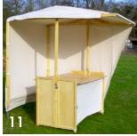
Bild 11 Rückenteil der Plane durch Lösen der Haltebänder herablassen. Sturmstützen St aufklappen, mittels Schraube sichern, rechts und links in untere Planenlatte (Rücken) einstecken, mit Druck nach unten spannen und oben in hintere Gabelscharniere einsetzen, Erdspieß
