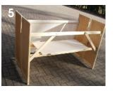
T auf A abgestützt-zweites T in ca. 1,5m Abstand positionieren, vorsichtig an A anheben & einstecken; abgewinkelt bleibt T auch so stehen;
